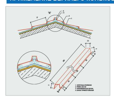
ДЛЯ ОСНОВЫ КОНЬКОВОГО ПРОФИЛЯ ЗАКРЕПЛЯЮТСЯ ДЕРЕВЯННЫЕ РЕЙКИ ВДОЛЬ ЛИНИИ КОНЬКА. К ЛИНИИ КОНЬКА ПОДГИБАЕТСЯ ЛИСТ ЧЕРЕПИЦЫ STARBOND. СВЕРХУ КОНСТРУКЦИИ УСТАНАВЛИВАЮТСЯ КОНЬКОВЫЕ ЭЛЕМЕНТЫ, НАКРЫВАЯ КРАЯ ЧЕРЕПИЦЫ. ПРЯМОУГОЛЬНЫЕ ЭЛЕМЕНТЫ КОНЬКА УКЛАДЫВАЮТСЯ С НАХЛЕСТОМ 100 мм, А ПОЛУКРУГЛЫЕ И У-ОБРАЗНЫЕ - С НАХЛЕСТОМ 20 мм. КРЫШКА КОНЬКА КРЕПИТСЯ ГВОЗДЯМИ К КОНЬКОВЫМ БРУСКАМ.
