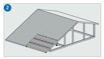
НА СТРОПИЛА МОНТИРУЕТСЯ OSB-ПОКРЫТИЕ, СВЕРХУ КОТОРОГО УКЛАДЫВАЕТСЯ ГИДРО- И ПАРО- ИЗОЛЯЦИЯ STARBOND FLEX SOFT.
