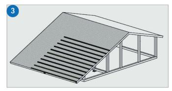
ПОВЕРХ STARBOND FLEX SOFT УКЛАДЫВАЕТСЯ ОБРЕШЕТКА ИЗ ДЕРЕВЯННЫХ РЕЕК СЕЧЕНИЕМ 50Х50 ММ С ШАГОМ 350 ММ. РАССТОЯНИЕ НИЖНИМИ ГРАНЯМИ ОБРЕШЕТКИ 370 ММ.
