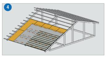
ПРОСТРАНСТВО МЕЖДУ РЕЙКАМИ ОБРЕШЕТКИ ЗАПОЛНЯЕТСЯ ТЕПЛОИЗОЛЯЦИЕЙ STARBOND PAN.
