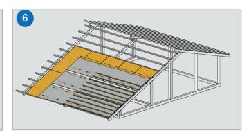
ПОВЕРХ ТЕПЛОИЗОЛЯЦИОННОГО СЛОЯ УКЛАДЫВАЕТСЯ ЧЕРЕПИЦА STARBOND И ЗАКРЕПЛЯЕТСЯ ПРИ ПОМОЩИ ГВОЗДЕЙ.
